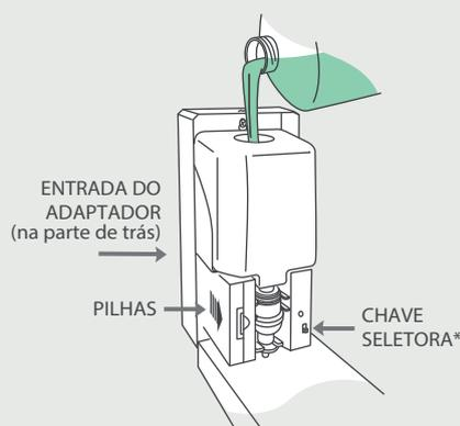
3. Coloque as pilhas ou conecte o adaptador na tomada. Abasteça e feche o painel;
