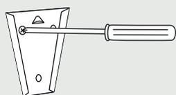
1. Fixe o suporte na parede com os parafusos;
