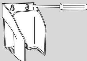
2. Fixe o suporte na parede com as buchas e parafusos;
